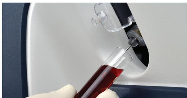
I campioni possono essere aspirati direttamente dalle provette. Il trasferimento del campione a una siringa o un capillare non è necessario.
