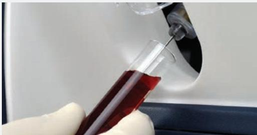
I campioni possono essere aspirati direttamente dalle provette. Il trasferimento del campione a una siringa o ad un capillare non è necessario.
