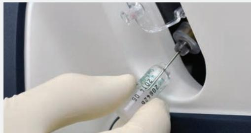
Il campionamento da fiale di verifica del CQ può essere effettuato senza l'impiego di adattatori.
